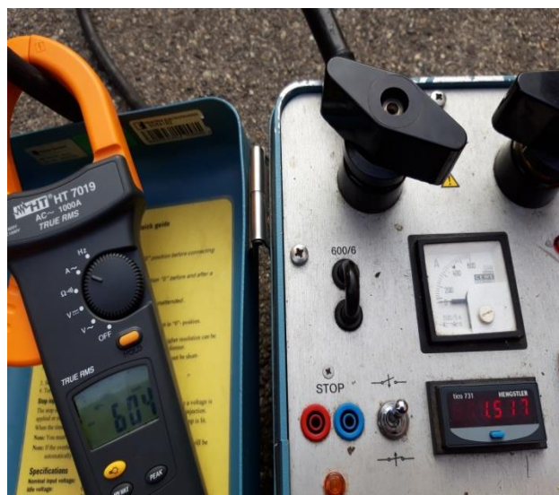
Slika 7. Struja prilikom testiranja i vrijeme taljenja vodiča
